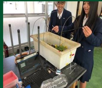
ハウスの開閉装置は「M5Stack」を使用して、生徒自らプログラミングします。
