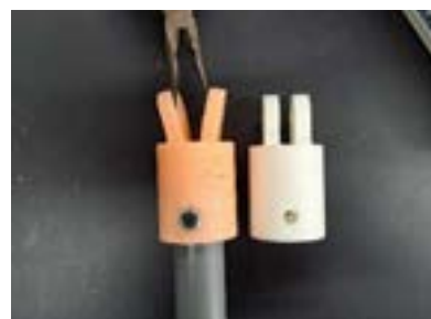
写真17：TPUとPLA比較（関節部品）
