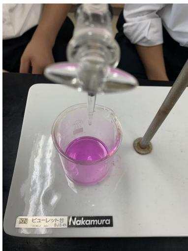
図1 滴定完了後のバイエルアスピリンのエタノール溶液
