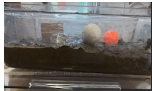
図3,4 液状化発生の例 (上 発生前 下 発生效后)
