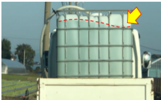
【図1】液肥を運ぶトラックのタンクの水面波の様子
