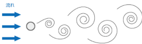
図1 カルマン渦を模式的に表した図
