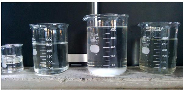
写真から、ろ過と凝集沈殿法をすときれいになることがわかる。
